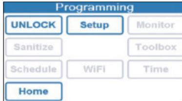
输入密码并选择“回车键” (Enter) 图标，即可解锁控件。如未设置密码，请参阅第10页设置密码。如果输入了错误的代码，请选择“清除” (Clear) 以重试。注意：只有输入正确密码后才能使用“回车键” (Enter) 图标。解锁后，控件会自动重定向至“编程” (Programming) 菜单，但这次“解锁” (UNLOCK) 图标将显示为“锁定” (LOCK) 图标，表示该控件已解锁，其它图标 (设置、监测、消毒、工具箱、时间表、Wi-Fi和时间) 此时均处于激活状态。
