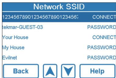
连接后，输入密码并选择“连接”（Connect）。
