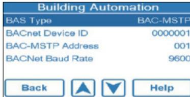
按“BACnet Device ID”，输入设备ID号，然后按“接受”（ACCEPT），即可更改BACnet设备ID。
