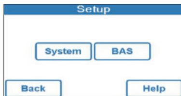
您可通过按“系统”（System）按钮设置系统操作，也可通过按“BAS”按钮配置BAS连接。如欲设置系统操作，请继续系统设置。关于如何打开并配置BAS连接，详见第17页。
